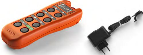
EVO 是艾科的标准手持式无线遥控器,适用于工业起重和搬运。它由6个双速按键,1个可编程的功能键,启动(通过可编程的激活密钥),蘑菇头急停组成。自动关机,防护等级IP65,内置锂电池(最多可连续使用20小时),专用充电器。可选配“主副控”和“多发射器”。
