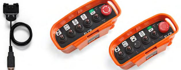
VETTA是紧凑型的腰挎式无线遥控器,功能强大且可靠,尺寸和重量更小。它最多可以控制9个功能,以及启动和停止功能。提供比例调节速度和4个反馈LED(E1系列)。可更换内部锂电池和专用充电器。可定制的控制面板和功能模式(可选)。
