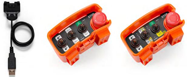
PIC是一种紧凑的腰挎式无线控制装置,体积小,重量轻,坚固可靠。专为满足广泛的应用而设计(与MITO和E1系统兼容)。标准配置包括3个选择开关和蘑菇形急停按钮,允许5个命令,若拨动开关功能复用(第二功能),最多8个命令。可充电锂电池和专用充电器。“CHECK”(检查)LED指示灯闪烁指示操作员目前发射器已连接接收器并准备接收发送的命令。
