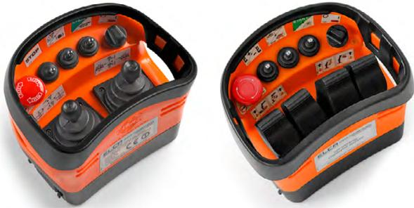
PUNTO是一款紧凑型摇杆式无线控制装置。标准配置有2个数字量摇杆，2个单轴或双轴比例摇杆或4个单轴摇杆，3个拨动开关，可拆卸的智能卡和急停蘑菇头。发射器可根据客户提供的规格进行定制。配有可充电电池和专用充电器。
