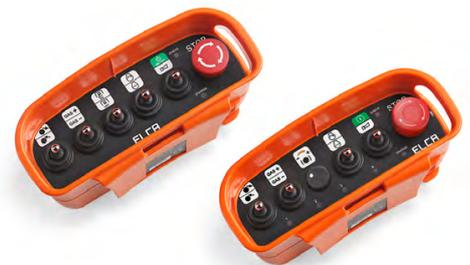
La poche compacte VETTA est une radiocommande à poche très solide et fiable aux dimensions et au poids limités. Elle permet de commander jusqu'à 9 fonctions plus le Start et Stop. Disponible également avec un réglage proportionnel et 4 LED de retour (série E1). Batterie interne au lithium, interchangeable rechargeable avec ELCA-CLIP. Panneaux et logique de fonctionnement personnalisables sur demande.
