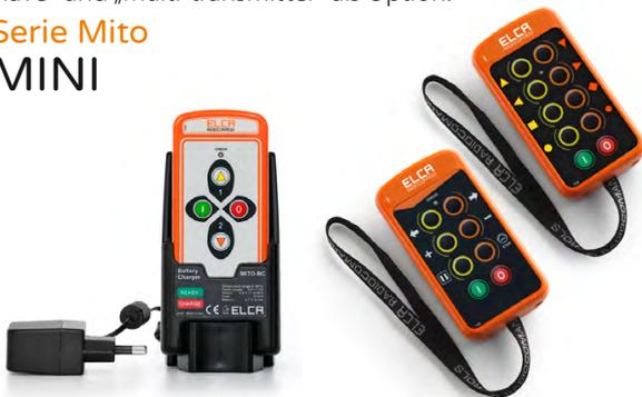
MINI ist eine kompakte Funkfernsteuerung für den Einsatz in den unterschiedlichsten Industrieautomatationen. Erhältlich in den Ausführungen mit 4 bis 10 einstufigen Drucktasten. Steuertafel und Betriebsart programmierbar, IP67, schwebend. Bidirektionale LBT-Technologie mit automatischem Frequenzwechsel ohne Unterbrechungen. „Check“-LED zur Kontrolle der Empfänger-Verbindung. Interner Lithium-Akku (bis zu 50 Stunden). Konfigurationen mit mehreren Sendern/Empfängern.
