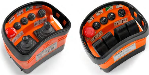
PUNTO ist eine kompakte Funkfernsteuerung mit Beckengurt. Standardkonfigurationen mit 2 Joysticks On/Off, Einzel- oder Doppelachse bzw. 2 proportionalen Joysticks oder 4 mit Einzelachse, 3 Kippschaltern, abziehbarem Aktivierungsschlüssel und Stopptaste. Der Sender kann nach den vom Kunden erteilten Spezifikationen individuell ausgelegt werden. Versorgung mit austauschbarem Akku mit Ladestation.
