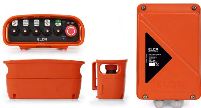
Modello VETTA: 5 selettori a 3 posizioni e stop con pulsante a fungo. Robusta, affidabile, ermetica (distanza operativa: 150 m). Il sistema di ricarica è integrato e la batteria è sostituibile.
