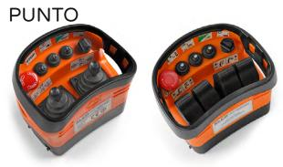
PUNTO è un radiocomando compatto a marsupio. Configurazioni standard con 2 joysticks on/off, singolo o doppio asse oppure 2 joystick proporzionali o 4 monoasse, 3 selettori a levetta, chiave di attivazione estraibile e pulsante di Stop. La trasmittente è personalizzabile secondo le specifiche fornite dal
